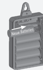
4. Die verbrauchten Batterien mit sechs neuen 1,5 V Lithium Mignon-(AA)-Batterien ersetzen.
