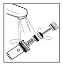
Bei zu langer Laufzeit: Kartusche innen mit Leitungswasser ausspülen In case of too long runtime: wash out the inside of the cartridge
