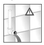
Wasserleitung spülen Flush the water supply-line
