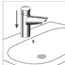
Selbstschlussventil auf Waschtisch aufsetzen, mit Mutter befestigen Place the Self-Closing Valve on the Washbasin, fasten with the Nut
